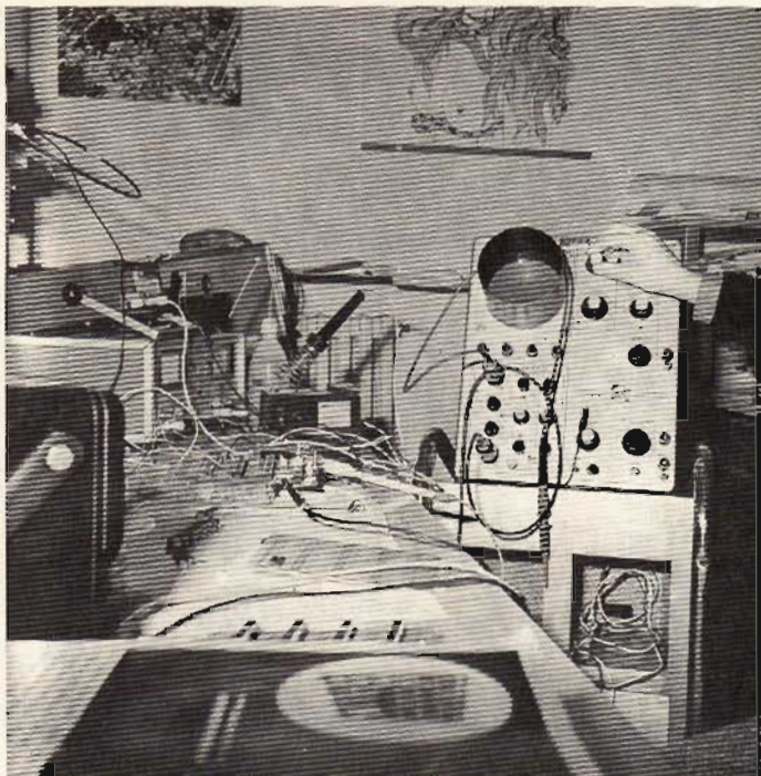
Fig. 13 - Primo piano del Tektronix 531A: la mano del tecnico sta agguistando il controllo della stabilità (sincro).
