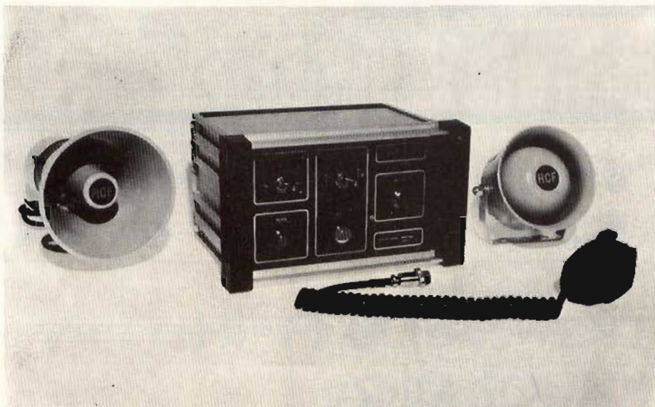
Fig. 2 - Apparecchiatura elettronica per l'emissione di segnali acustici ed amplificazione della voce della Electronic Design.
