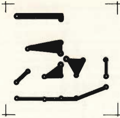
Fig. 31 - Circuito stampato dell'amplificatore di sincronismo.
